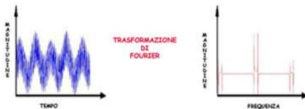
Figura 11. La trasformazione di Fourier permette di passare dal dominio del tempo a quello della frequenza.
