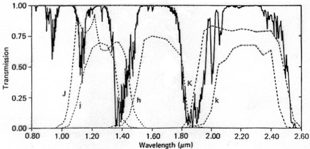
Fig. 3.2 – *Trasmissione atmosferica estiva di Kitt Peak nel vicino infrarosso. Le curve di trasmissione per i filtri di Johnson J e K, e i filtri Kitt Peak J, H e K (indicati con j, h e k) sono rappresentate dalle linee tratteggiate.*
