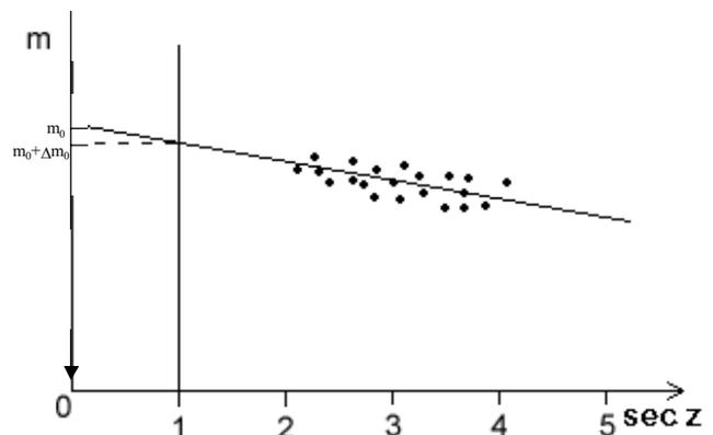
*Metodo di stima di  $m_0$  e  $\Delta m$  da misure della magnitudine  $m$  misurata con un telescopio a diversi valori di  $\sec Z$ .*
